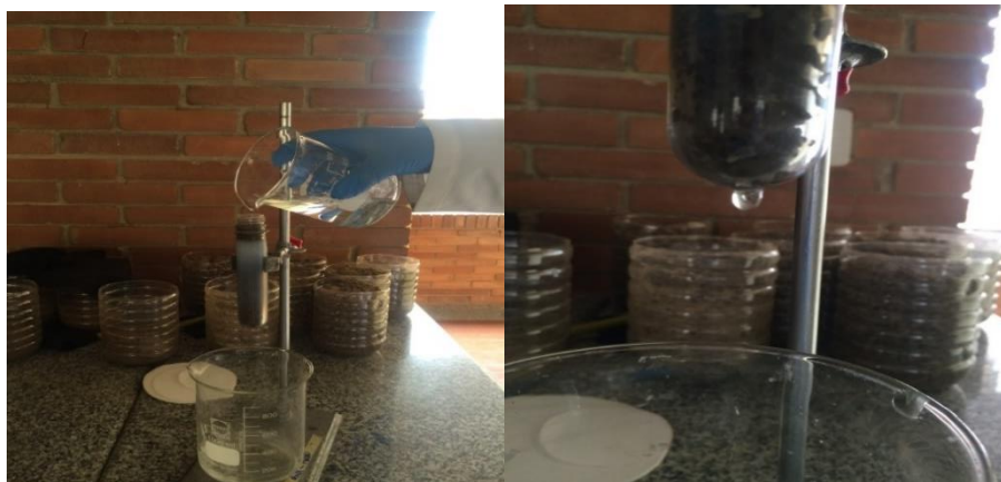
Foto 2. Prueba de retención de agua.
