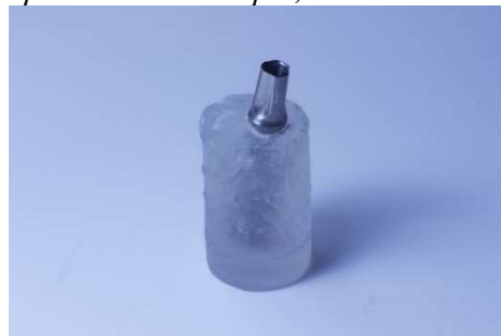
Figura 6. Conexión de pilar y aplicación de torque, 35 Nw.
