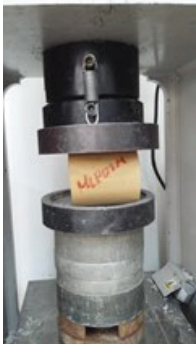
Figura 11. Probeta fallada en ensayo de compresión perpendicular.
