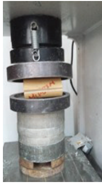
Figura 12. Aplastamiento en el ensayo por compresión perpendicular.
