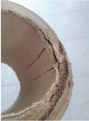
Figura 5. Ensayo de compresión paralela a las fibras.
