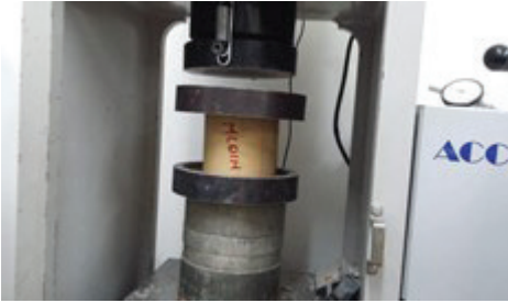
Figura 5. Ensayo de compresión paralela a las fibras.
