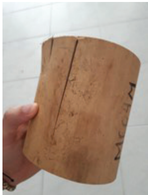
Figura 6. Probeta fallada en el ensayo de compresión paralela.
