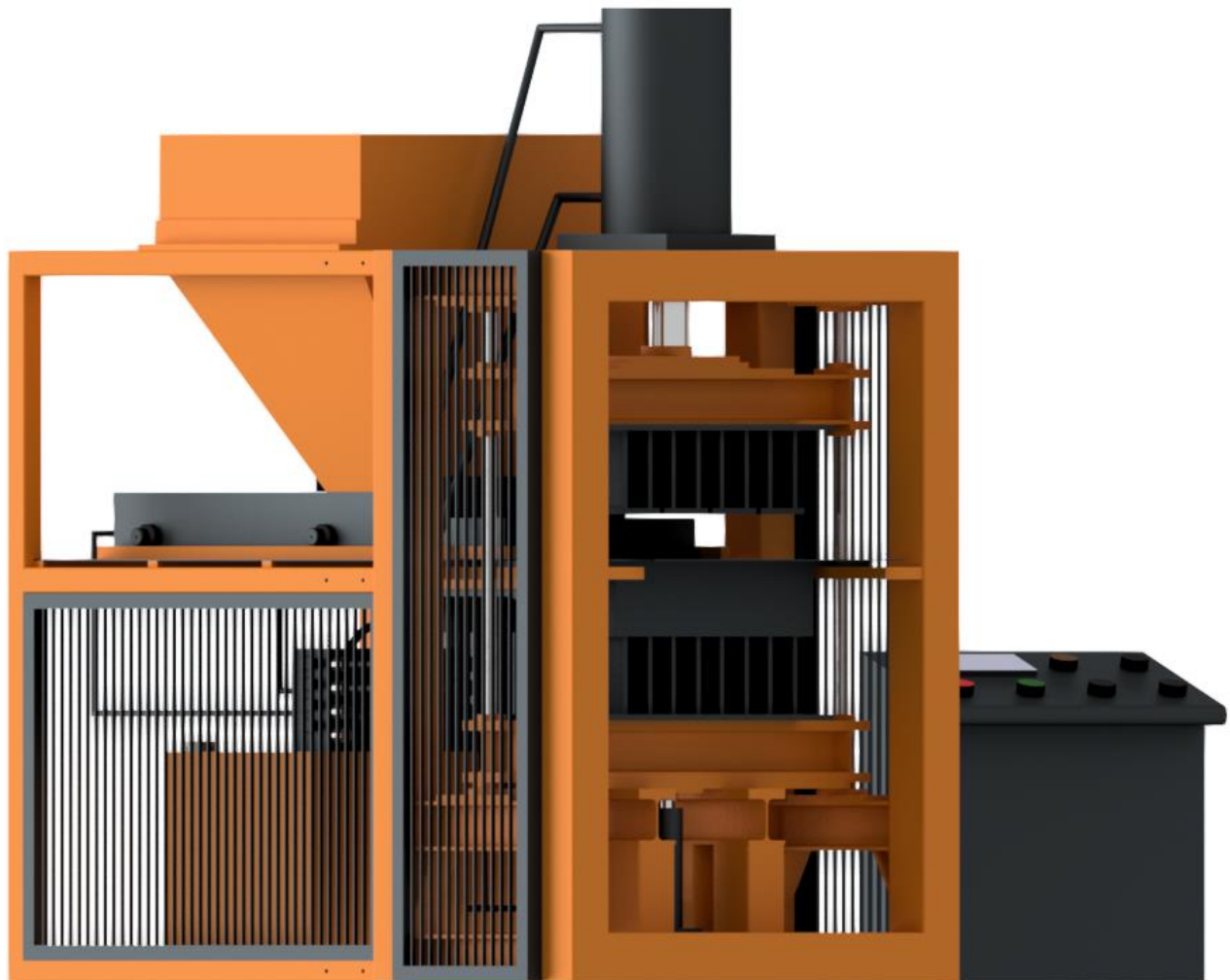
Figura 3. Diseño CAD de la prensa hidráulica para fabricación de ladrillos
