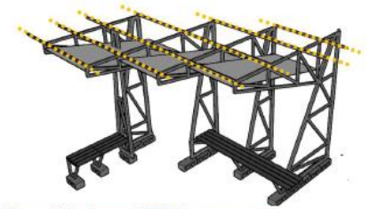
Ilustración 7. Proyecto OASIS. Estructura; correas
