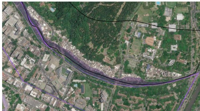
Figura 14. Polígono de riesgo por avenida torrencial - parte baja de la cuenca
