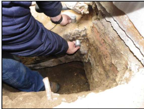
Figura 11. Medición con equipo ultrasonido. Fuente: Propia
