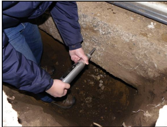
Figura 12. Medición resistencia superficial con Esclerómetro. Fuente: Propia
