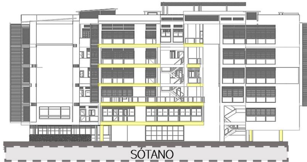
Figura 142. Porcentaje de concreto en fachada este
