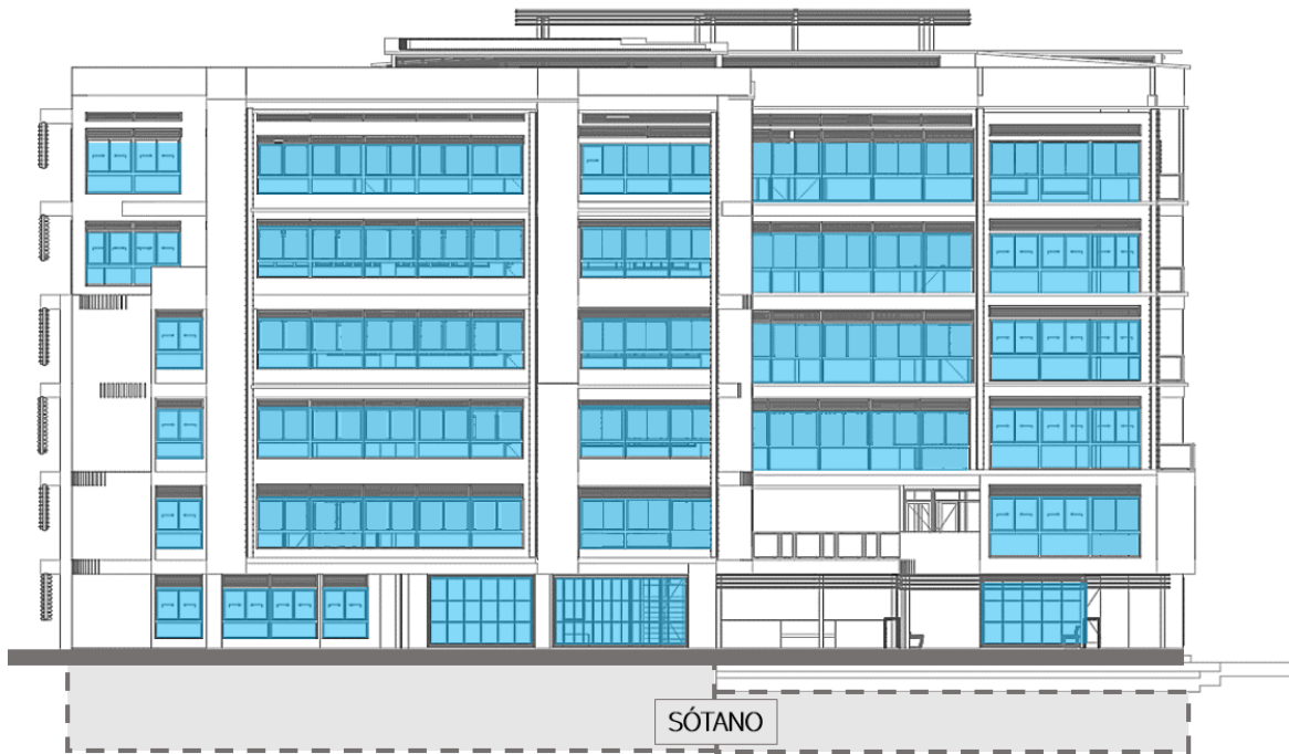
Figura 137. Acristalamiento de fachada norte
