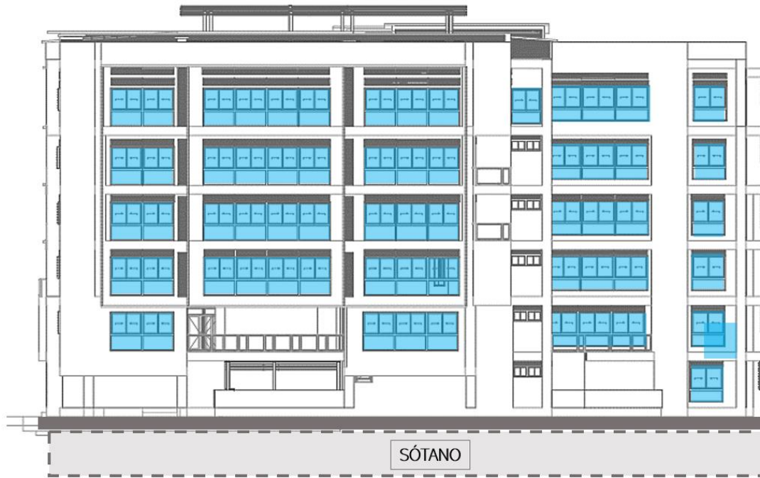
Figura 136. Acristalamiento de fachada norte
