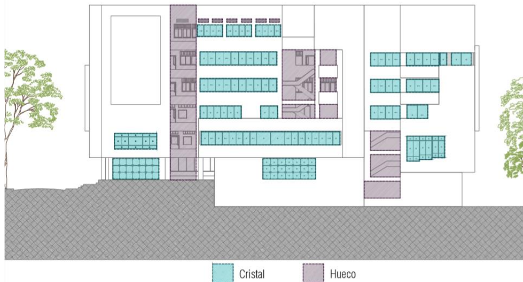
Figura 85. Total, perforaciones y acristalamiento en la fachada Este
