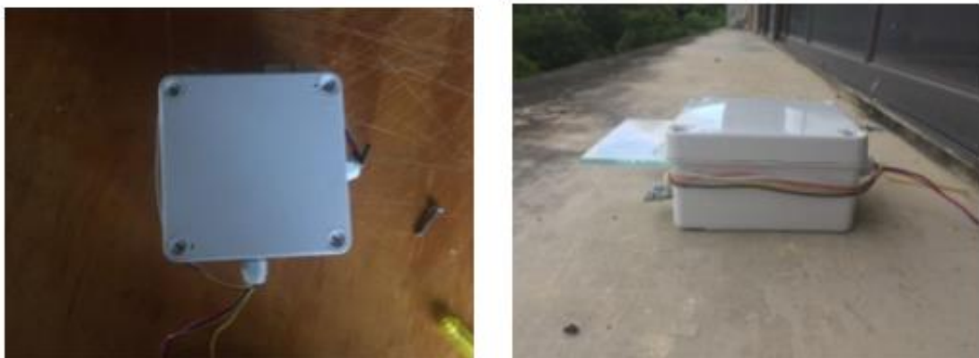
Figura 45. Instalación de nodo en el punto de medición, fachada del Fray Angélico
