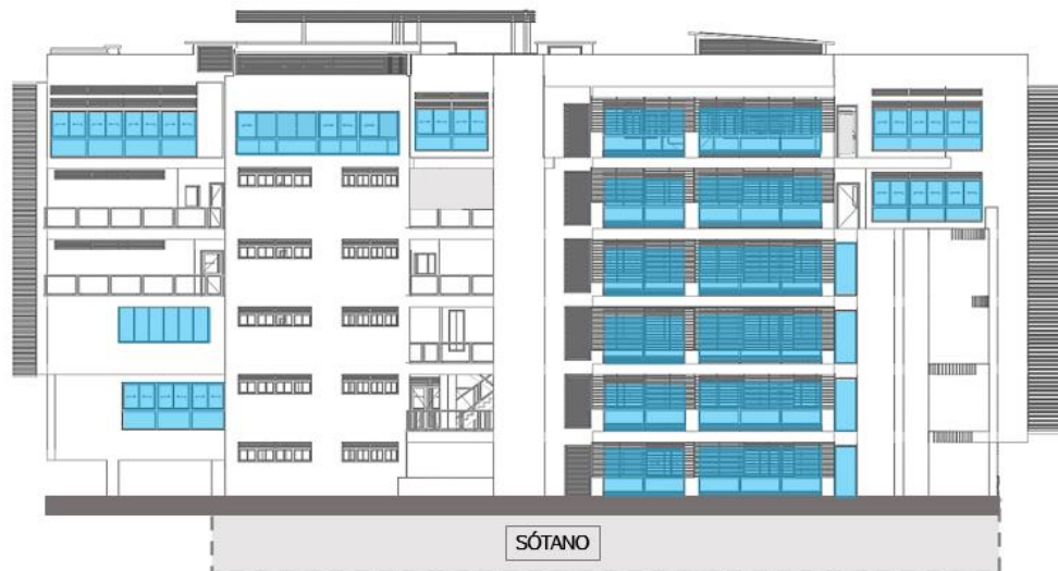
Figura 134. Acristalamiento de fachada oeste
