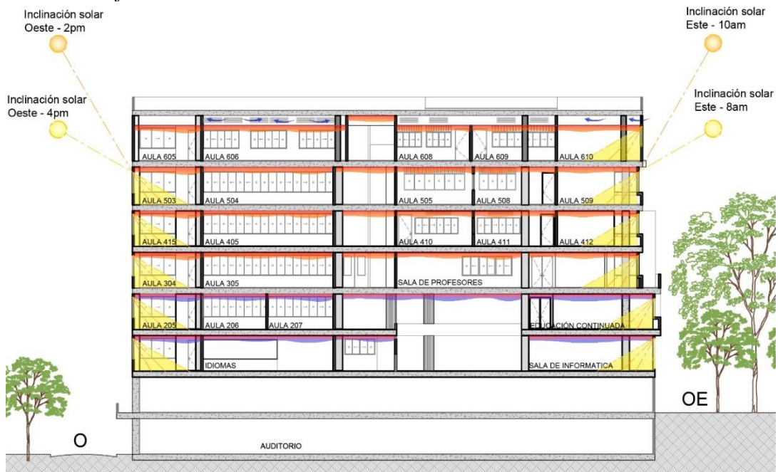
Figura 71. Corte fachadas Este - Oeste
