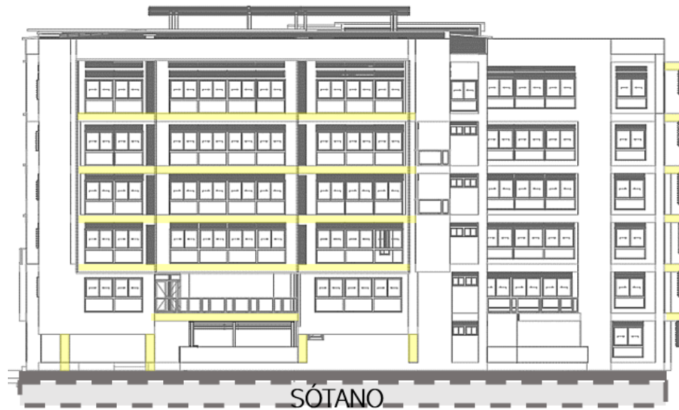
Figura 146. Porcentaje de concreto en fachada norte
