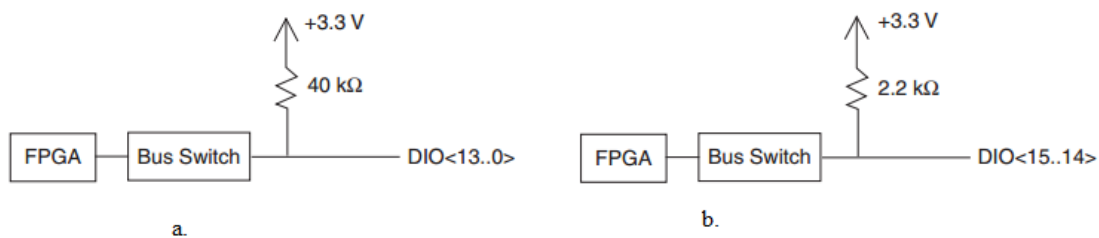
Figura.A.3 conexión interna líneas DIO conector MXP a. DIO <13..0> b. DIO <15..14>
