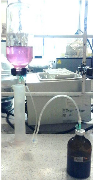
Figura 5. Montaje para la medición de biometanización por desplazamiento alcalino.
