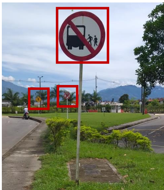
Figura 9.13 Señales “Prohibido Dejar o Recoger Pasajeros”, “No Parqueo/Ni Detenerse” y “Zona de Peatones”–Tramo B (Julio 2020) Fuente: Elaboración propia a partir de inspección
