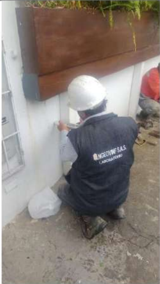
ENSAYO DE ESCLEROMETRO
