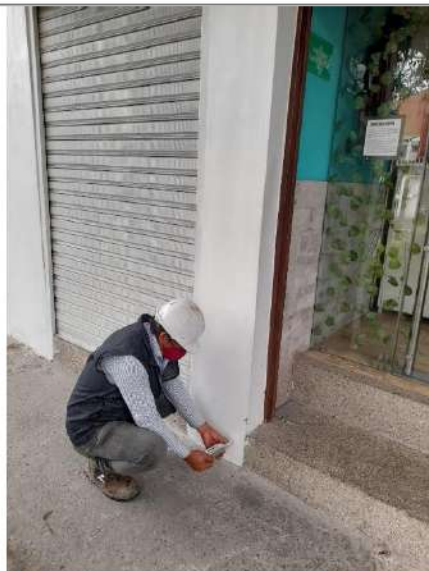
ENSAYO DE ESCLEROMETRO
