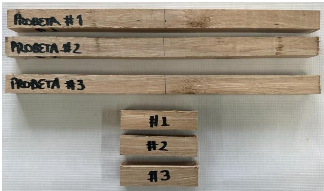
Imagen 7. Probetas de madera obtenidas para ensayos mecánicos de flexión estática y compresión paralela
