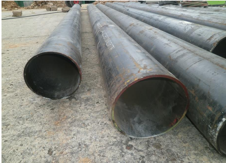
Ilustración 41. Estructura metálica en tubo 10-3/4" – Columna.
