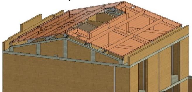
Figura 15. Vista 3D colocación de Teja.
