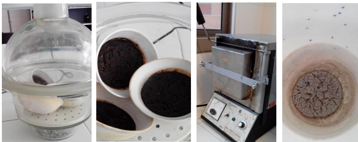
Figura 3. Determinación de sólidos totales y sólidos volátiles totales, equipo disponible en el laboratorio de biotecnología UIS.
