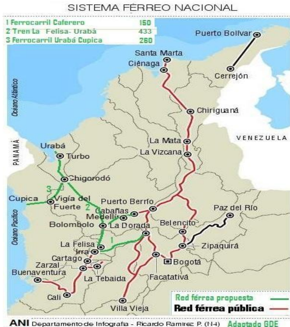
Figura 3 Red ferroviaria actual (ANI) en rojo y negro, y red propuesta (GDE) en verde, con el Ferrocarril Cafetero, el Nuevo Ferrocarril de Antioquia y el Ferrocarril Verde del Atrato entre Urabá y Cupica Fuente: Red Cultural del Banco de la República
