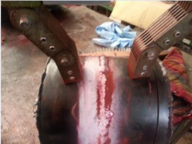
Figura 25 Magnetización de la probeta
