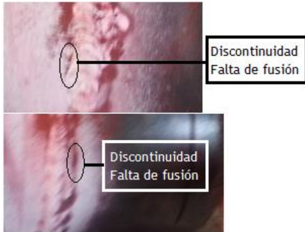
Figura 100 Discontinuidad de falta de fusión
