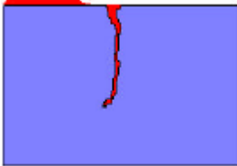
Figura 22 Limpieza del exceso de líquido penetrante
