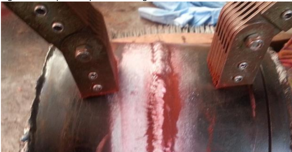
Figura 101 Inspección partículas magnéticas
