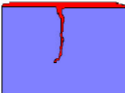
Figura 20 Aplicación del líquido penetrante
