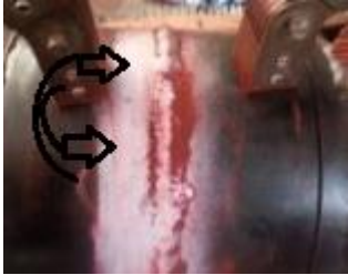
Figura 98 Movimiento del yugo
