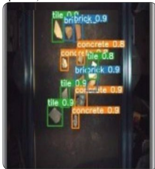
Figura 9. Resultados de inferencia en imágenes que contienen muestras desequilibradas de clase (extraídas de set_1 de prueba).
