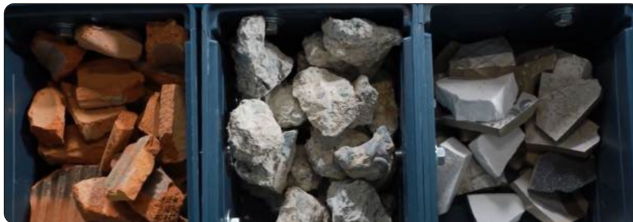
Figura 11. Muestras separadas de RCD: separación realizada por brazos robóticos sistematizados
