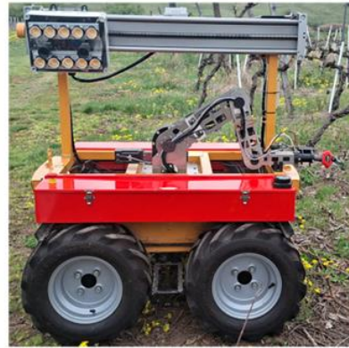
Figura 6. Gemelo digital y transferencia del modelo de navegación del rover Grapler. (a) arquitectura del entrenamiento virtual y transferencia al robot físico; (b1) prototipo físico Grapler y (b2) su representación digital en Unity.
