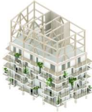
Figura 11. Esquema modular de estructura, Wooden Tower
