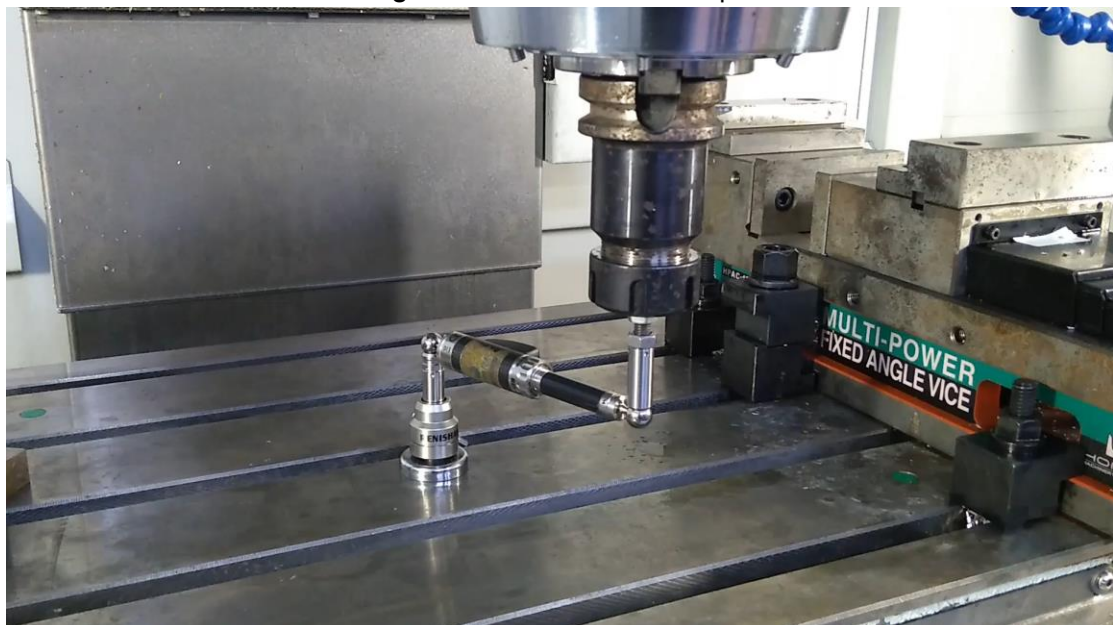
Imagen 2. Prueba Ball-bar en proceso.
