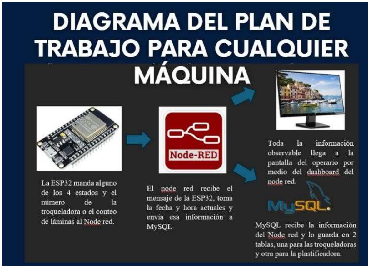
Figura 1 : Diagrama del SCADA MISA instalado en la empresa de Carbolsas S.A.S
