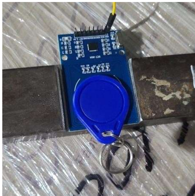
Figura 14: Ranura donde se ubicó la RFID para la toma de datos de la troqueladora, con sus respectivas protecciones.
