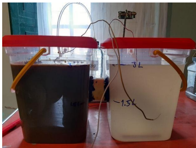
Fase V. Celda de combustible microbiana a escala banco
