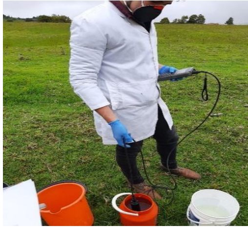
Toma de datos de parámetros fisicoquímicos mediante el multiparametro
