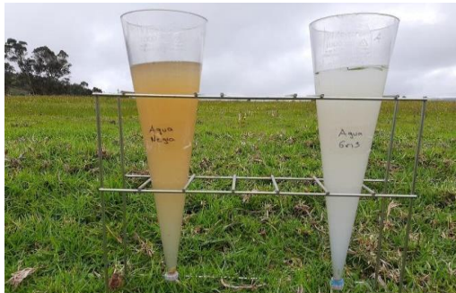
Análisis de solidos sedimentables (Conos de Imhoff)
