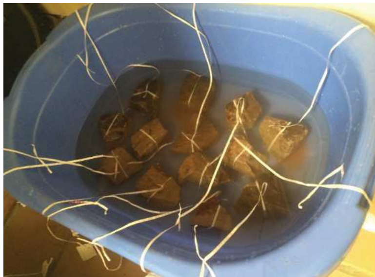
Imagen No. 49: Saturación de muestras en Agua Destilada para los ensayos de Propiedades Físicas Básicas
