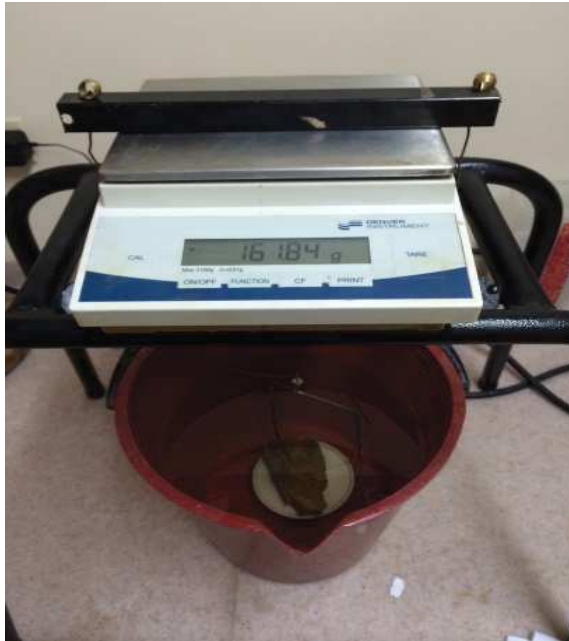
Imagen No. 50: Determinación del peso hidrostático por inmersión total de la muestra
