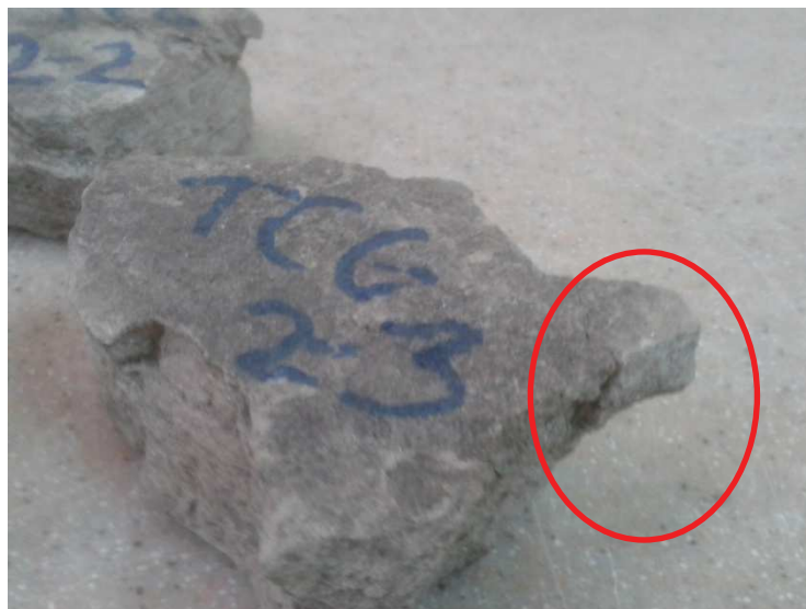
Imagen No.61: Formación de grietas en el ensayo de resistencia a los cambios de humedad
