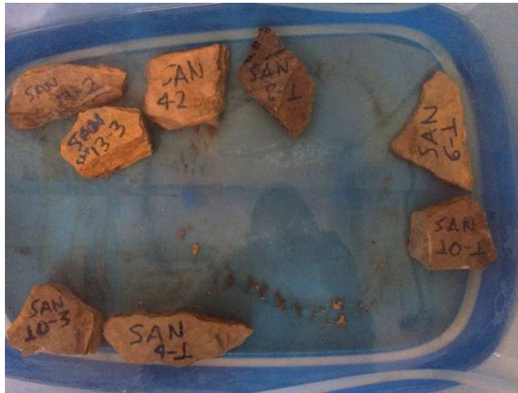
Imagen No. 60: Desprendimiento de partículas en el proceso de saturación del ensayo de resistencia a los cambios de humedad
