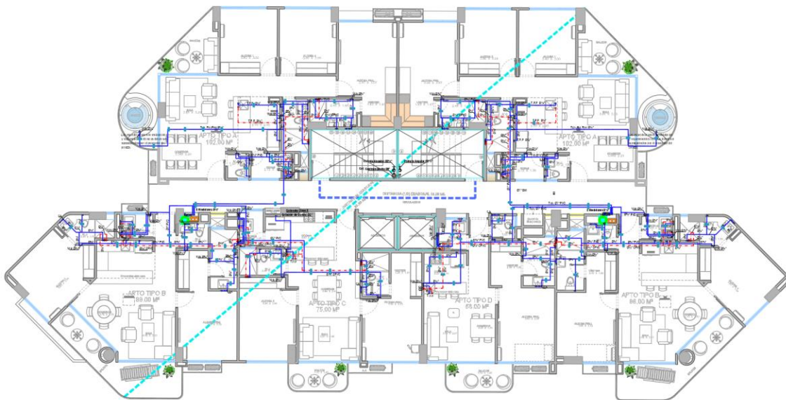
Figura 13. Plano hidráulico- Piso 5-15
