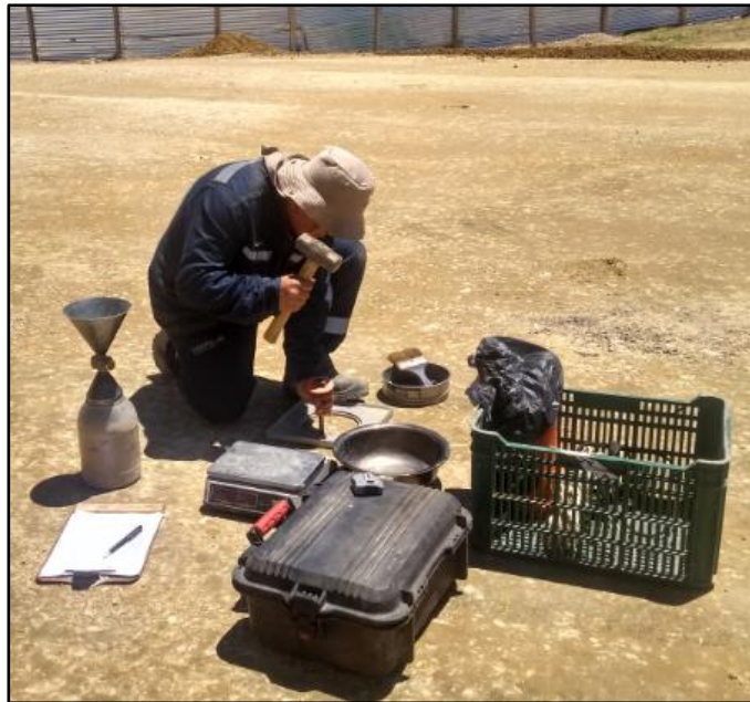
Figura 6. Equipo necesario ensayo cono de arena.
