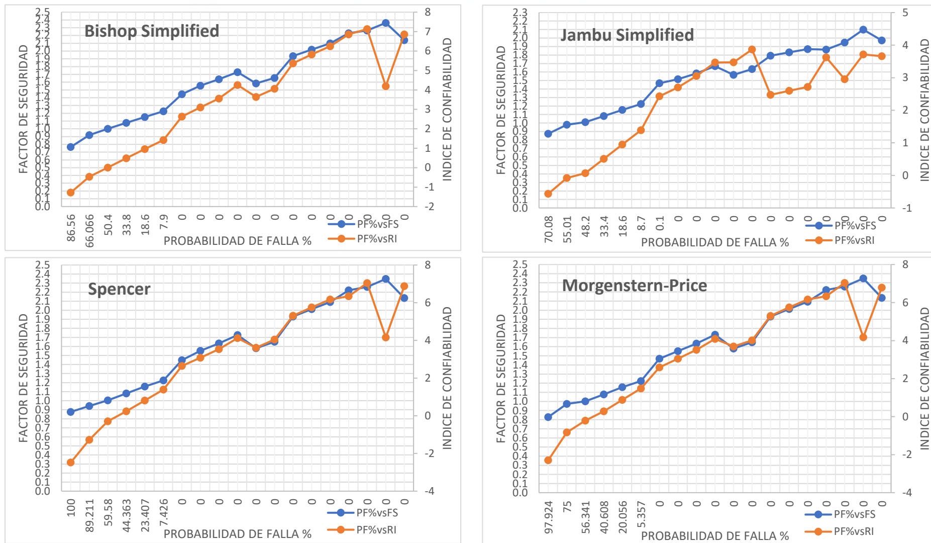
Figura 38. Relación entre el factor de seguridad el índice de confiabilidad, y la probabilidad de falla, evaluados para Spencer, Bishop Simplified, Jambu Simplified y Morgenstern Price para un ángulo de fricción efectiva con varianza de 11,2% y cohesión de 80%.
