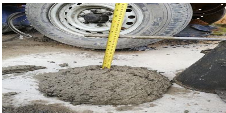
Ilustración 4 Slump concreto aplicado en las columnas B1TA nivel
