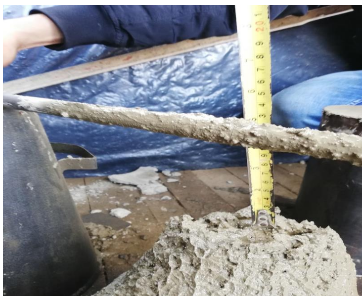
Ilustración 18 Slump concreto columnas B1TB Nivel 3
