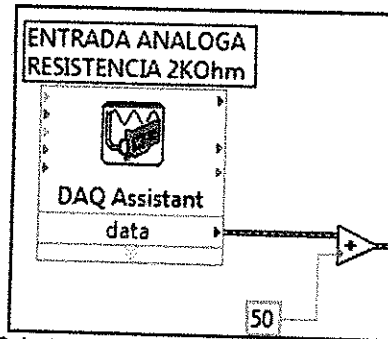
Figura 158. Instrumentos virtuales para configuración del Offset. Fuente. Autores
