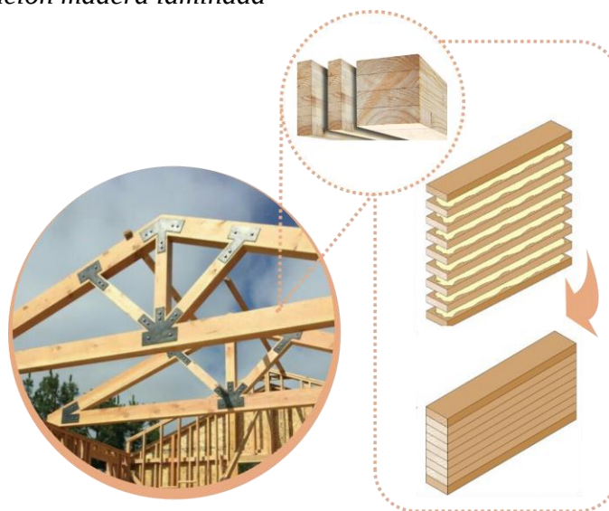
Figura 106. Fabricación madera laminada
