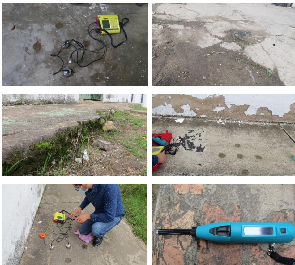
Imagen 47 Ensayos de ultrasonido y esclerometría
