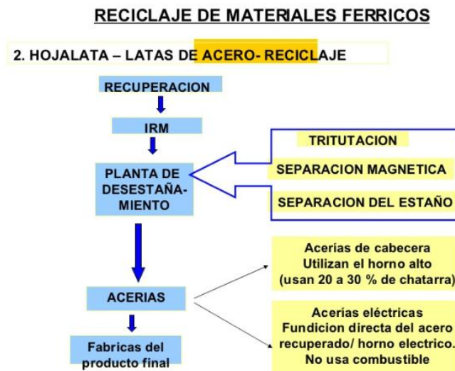
Figura N° 40 Esquema aprovechamiento materiales férricos
