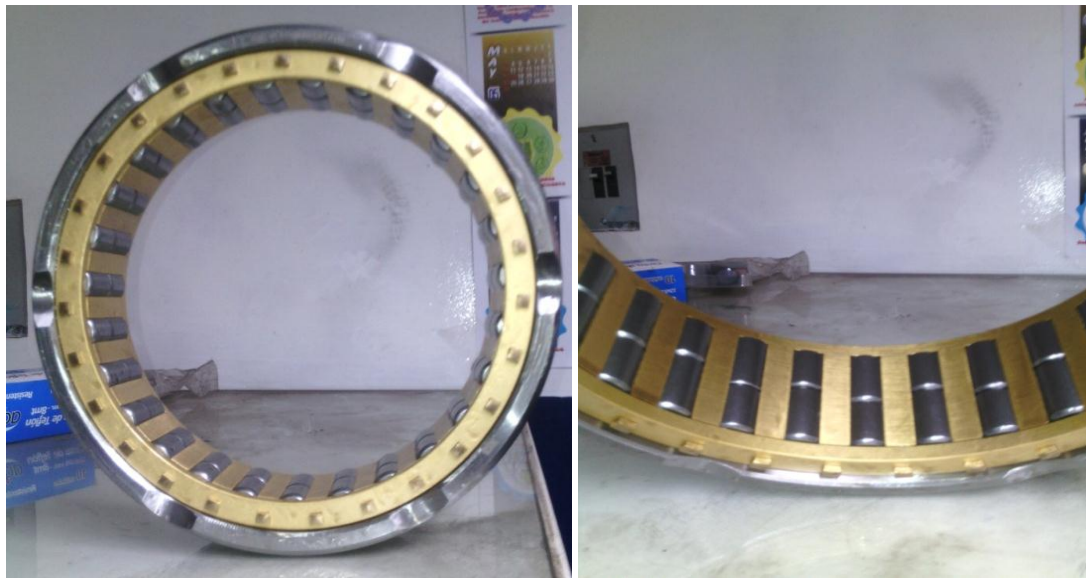
Imagen 15. Rodamientos de cilindro de doble hilera tipo Radial
