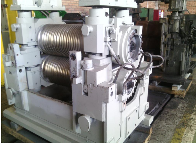
Imagen 12. Caja de laminación tren dos
