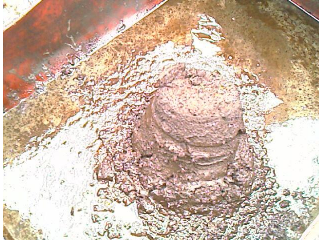
Figura 8. Residuos sólidos, (borras) extraídas del interior de los tanques.
