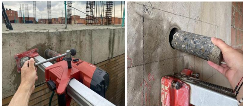
Ilustración 18 Toma de datos ensayo Extracción de Núcleos
