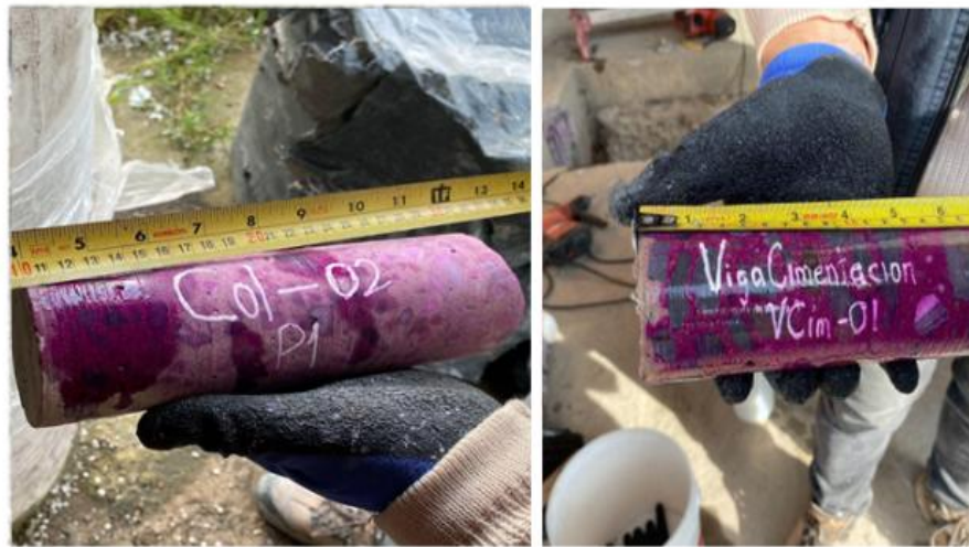
Ilustración 19 Toma de datos ensayo profundidad de carbonatación
