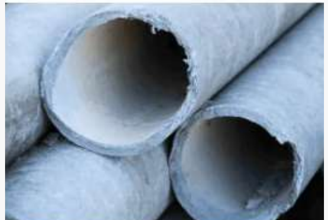
Conductos de agua, canalones, bajantes de fibrocemento
