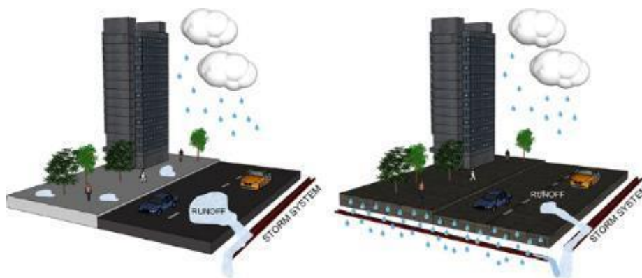
Figura 20. Diferencias entre un pavimento permeable e impermeable.
