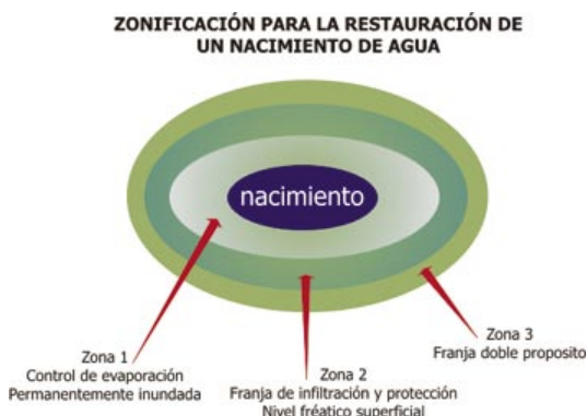
Fig. No. 42. Zonificación de área de ronda de un nacedero para su restauración.
