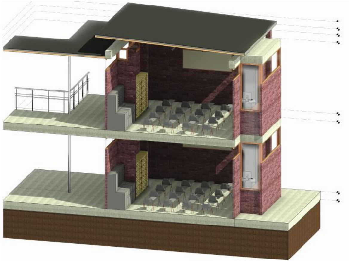
Figura 34. Corte fachada aulas tipo.
