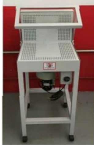
Figura 56. Cabina de aspersión de pegante.
