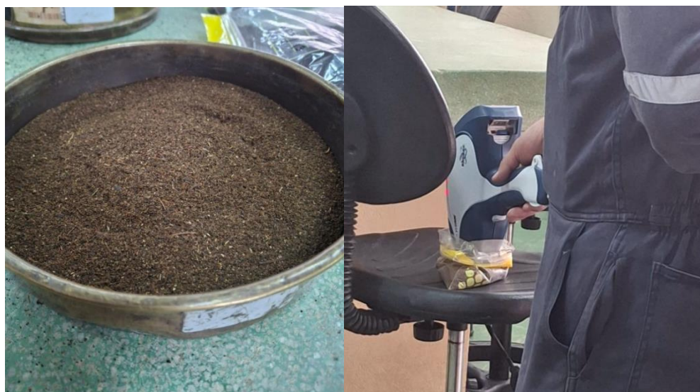
Figura 19 a, b. Análisis con pistola XRF.
