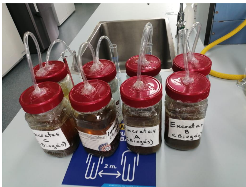
Figura 17: Montaje experimental realizado para la obtención de biogás. Realizado por: Ariza y Pinzón 2020
