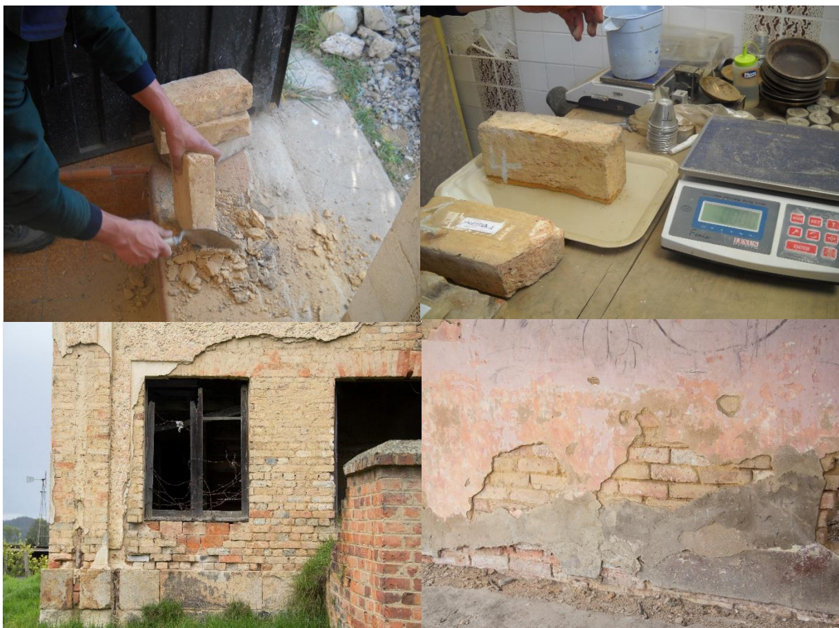
Figura 28. Estimación de vulnerabilidad a partir de la distribución de los ladrillos.
