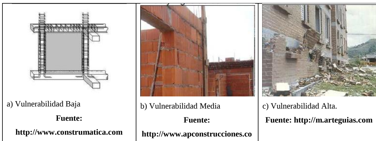
Figura 33. Refuerzo en columnas y vigas de confinamiento.
