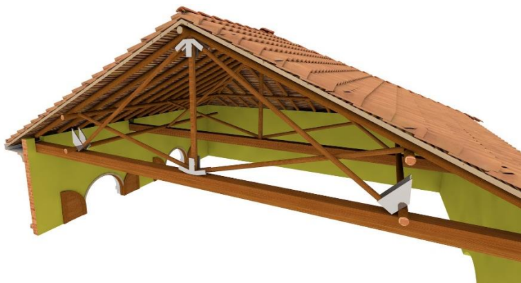
Figura 105, Reforzamiento en Cubierta.
