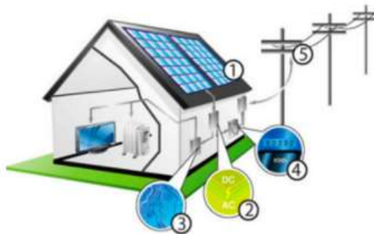
Figura 9. Sistema fotovoltaico sistema conectado a la Red pública.
