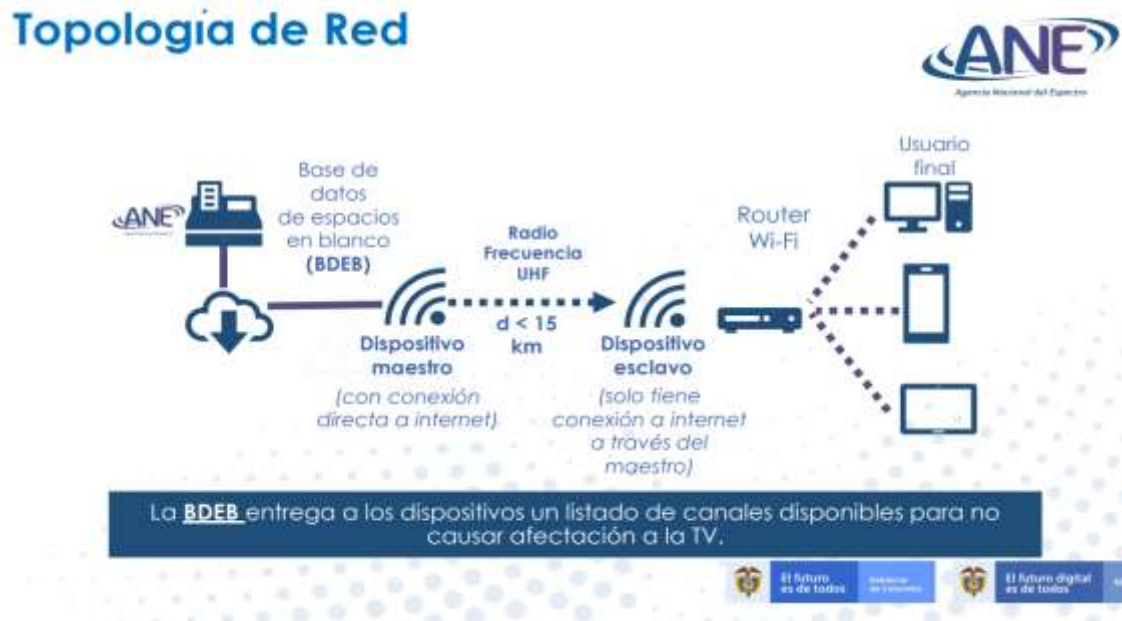
Figura 37. Arquitectura sistema TVWS [35].
