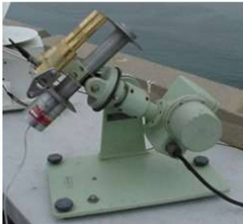
Figura 16. Pirheliómetro Eppley de incidencia normal (montado sobre un seguidor de Sol). Fuente: IDEAM [24].
