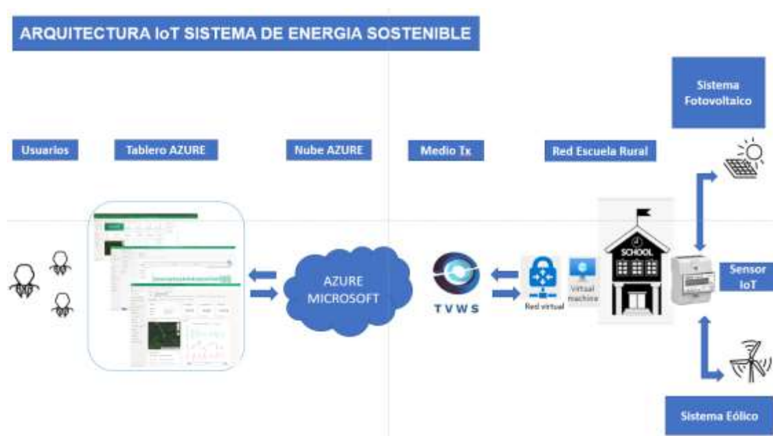
Figura 41. Arquitectura IoT Sistema de energía sostenible.
