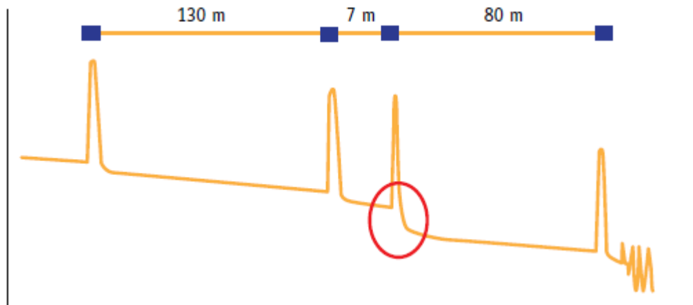
Grafica 2. Visualización OTDR con Elevadas Pérdidas en Conector a 137m.
