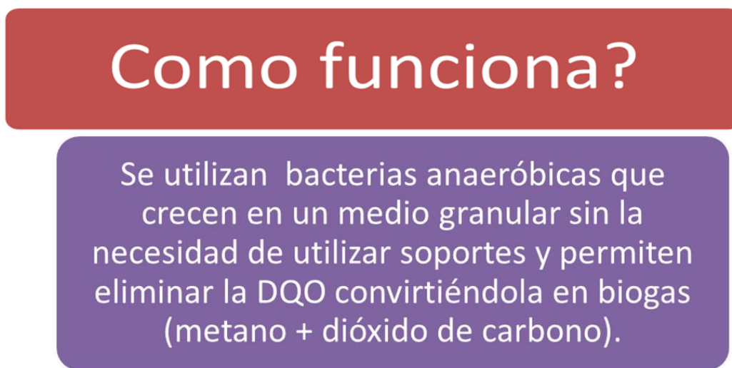
Figura 28. Funcionamiento PTAR Plaza de mercado de Piedecuesta
