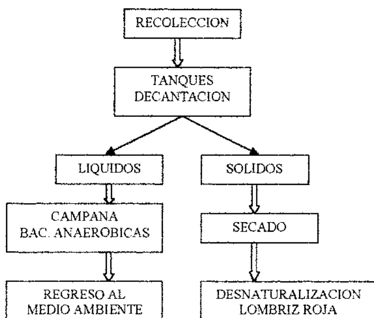
Gráfico 139. Diagrama de flujo de aguas residuales.
