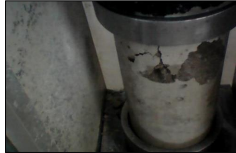
Ilustración 26- Cilindro después de realizar el ensayo de compresión
