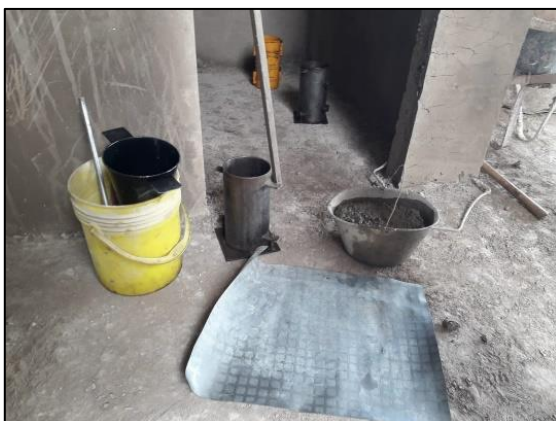
Ilustración 22- Materiales usados en la elaboración de cilindros
