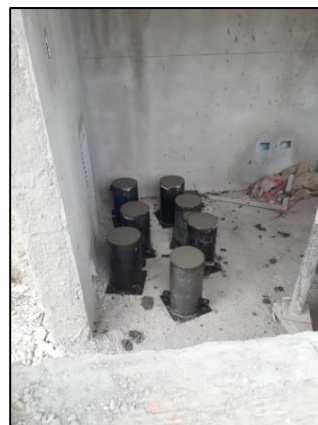
Ilustración 23- Cilindros para ensayo de resistencia a compresión 22
