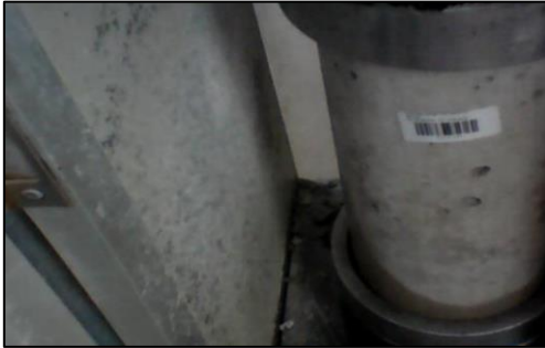
Ilustración 25- Cilindro antes de realizar el ensayo de compresión
