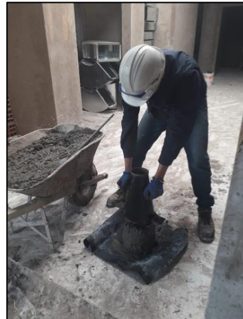
Ilustración 21- Elaboración ensayo de asentamiento
