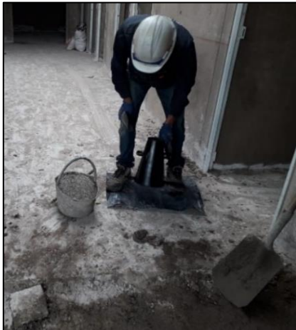
Ilustración 20- Elaboración ensayo de asentamiento
